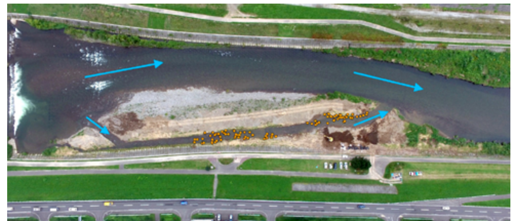
図4 サケ産卵環境改善試験工事前（上）と工事後（下）の空撮写真。オレンジのポイントは確認されたサケ産卵床の位置。撮影・北英建設
